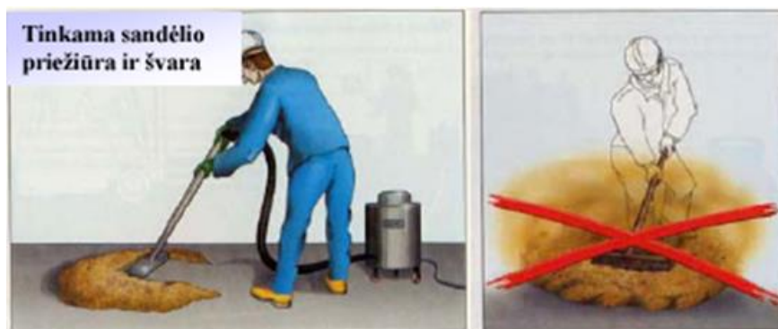
4 pav. Tinkamo ir netinkamo dulkių tvarkymo pavyzdžiai
